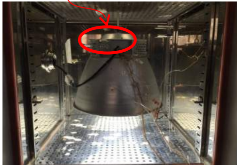
コンバータ内蔵器具の測定
